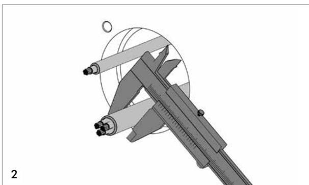
Anzuschließende Versorgungsleitungen durchschieben und die Durchmesser der Leitungen bestimmen.
