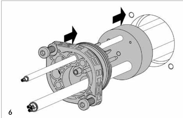
Ringstopfen (Sekundärdichtung) aus dem Zubehörset entnehmen. Abdichteinheit montieren. Zuerst den Ringstopfen (Sekundärdichtung) aufschieben, anschließend die Abdichteinheit.
