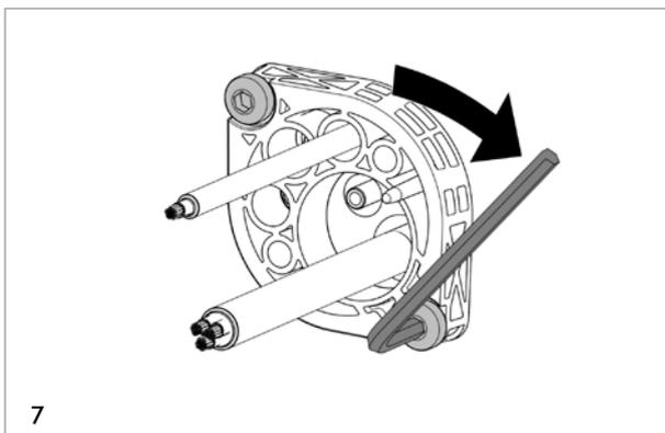
Befestigungsschrauben (Innensechskantschraube) abwechselnd anziehen bis die Stopfbuchsbrille an der Ankerplatte plan anliegt.
