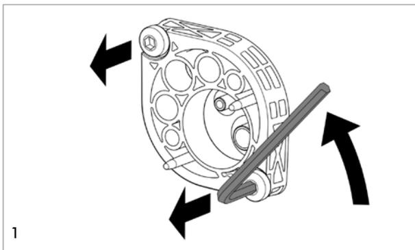
Befestigungsschrauben (Innensechskantschraube) der Stopfbuchsbrille Telekommunikationsleitungen (Verschlussstopfen orange) lösen. Abdichteinheit an den Schrauben herausziehen.
