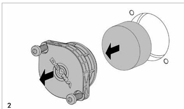
Abdichteinheit mit dahinterliegender Sekundärdichtung herausziehen.
