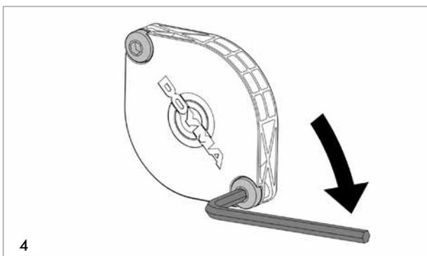
Befestigungsschrauben (Innensechskantschrauben) abwechselnd anziehen bis die Stopfbuchsbrille an der Ankerplatte plan anliegt.
