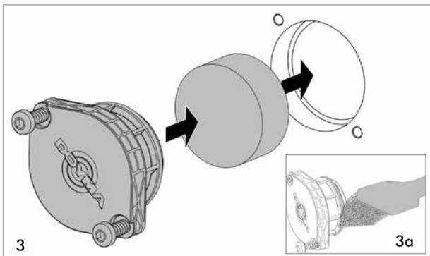
Sekundärdichtung und Abdichtelement montieren.
